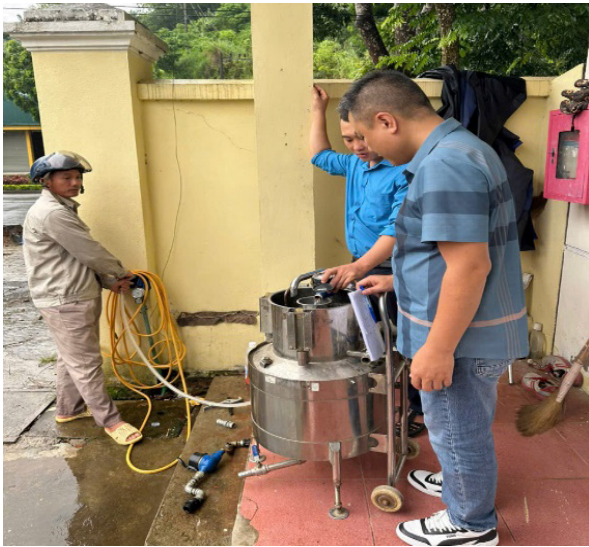
Kiểm tra đồng hồ đo nước lạnh tại chi nhánh Công ty nước sạch Phong Thổ
